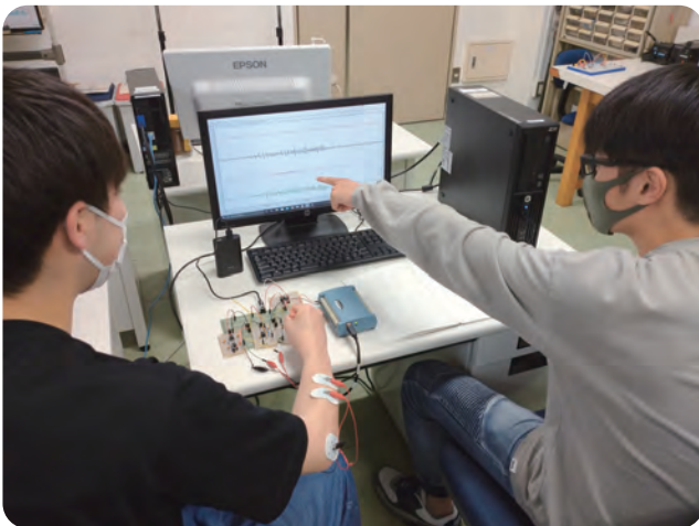
筋肉などの生体情報を電気信号として検出
